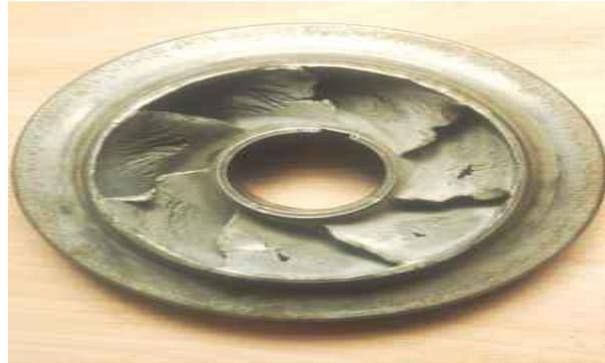
**Figure I.19:** Roues endommagées par le phénomène de la cavitation. [27]
