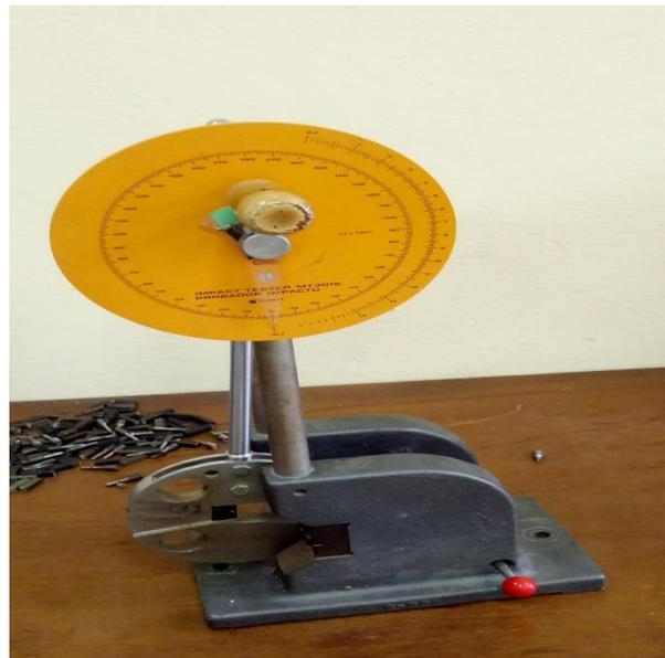
**Figure III.2 :** Mouton pendule de Charpy
