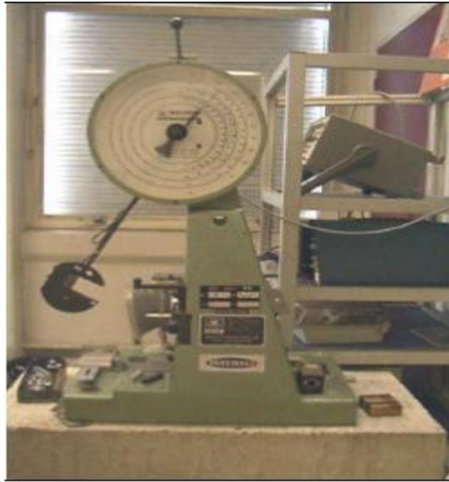
Figure II.13 : Une machine de Charpy [9].
