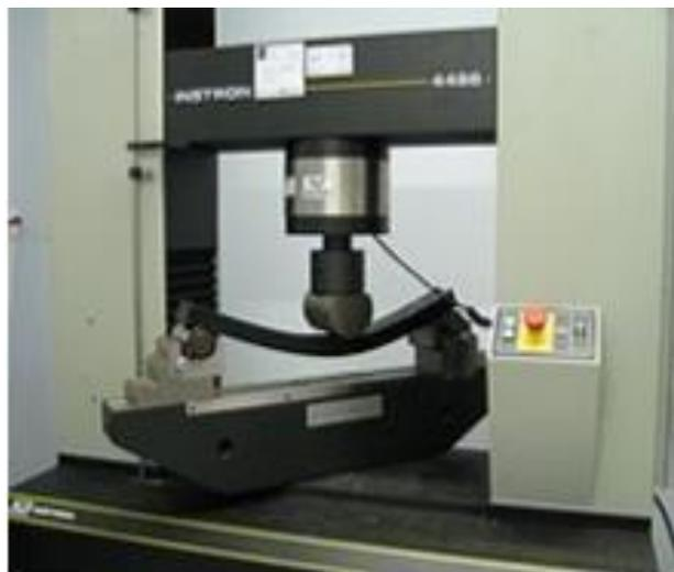
**Figure II.16 :** Essai de flexion « trois points » d'une poutre [16].
