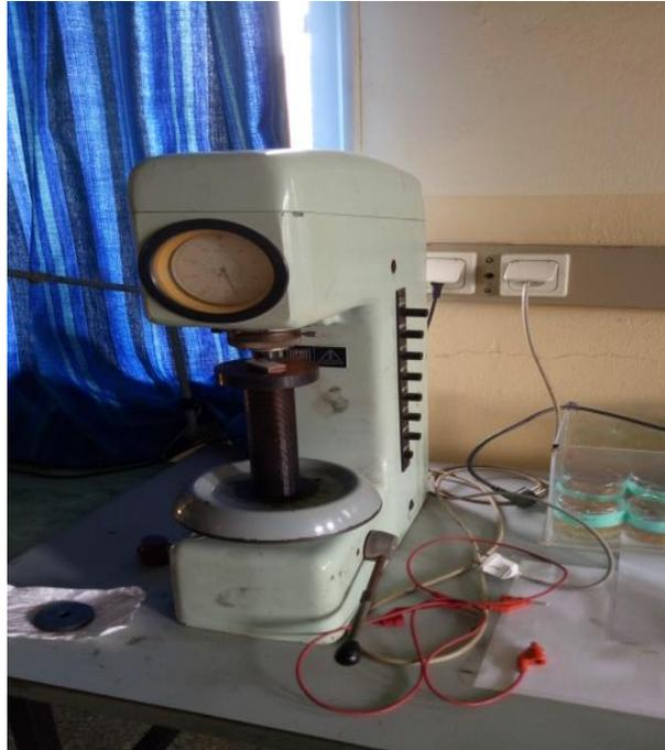
**Figure III.9 :** Duromètre universel.
