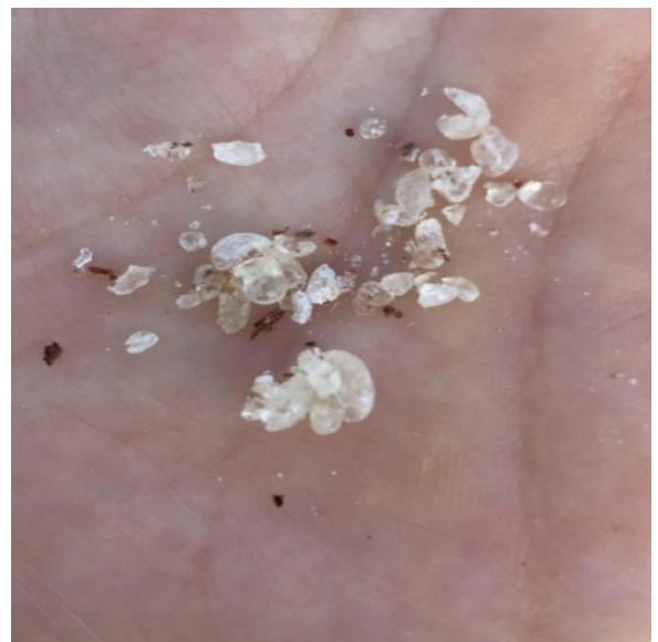
Figure 5: Gouttelettes séchées du mastic.
