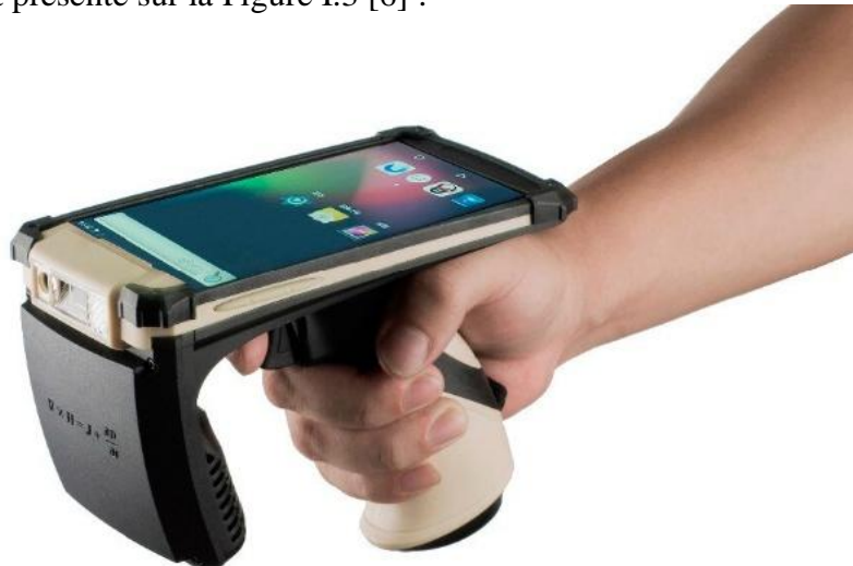
Figure I.3 : Lecteur RFID portable [8].
