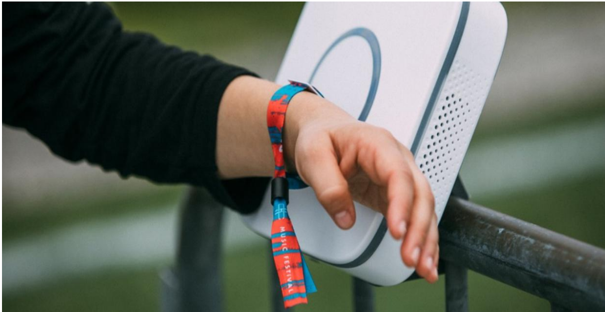
Figure I.10 : Contrôle d'accès par bracelet RFID [14].
