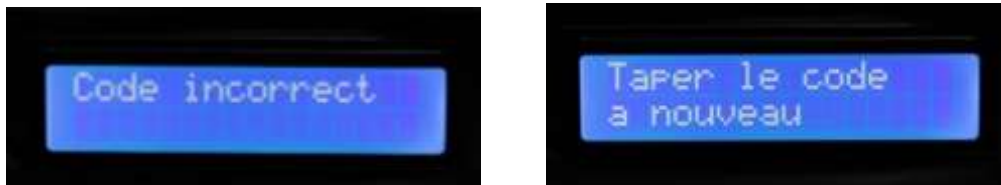
Figure IV.14 Affichage du message « Code incorrect taper le code à nouveau »
