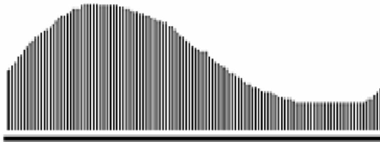
**Figure II.3** : Modèle de fluctuation Swerling I
