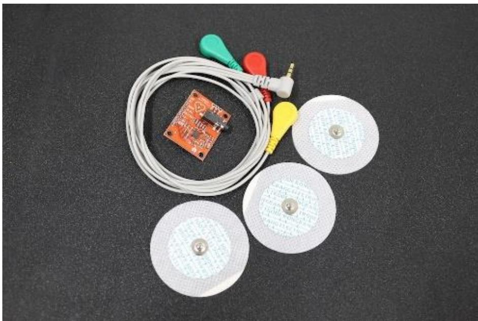
Figure III.2-6 électrode et câble pour moniteur de fréquence cardiaque AD8232 [14]
