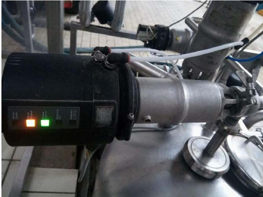
**Figure II.9 :** Image illustrative d'une vanne automatique.
