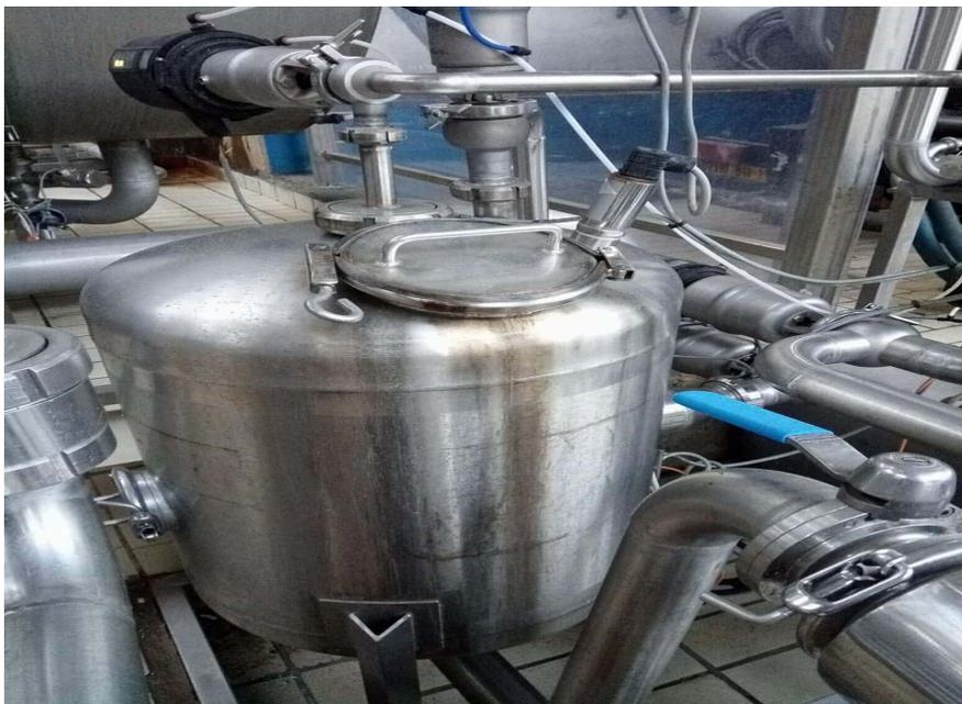
**Figure II. 3 :** Illustration d'un bac de lancement.
