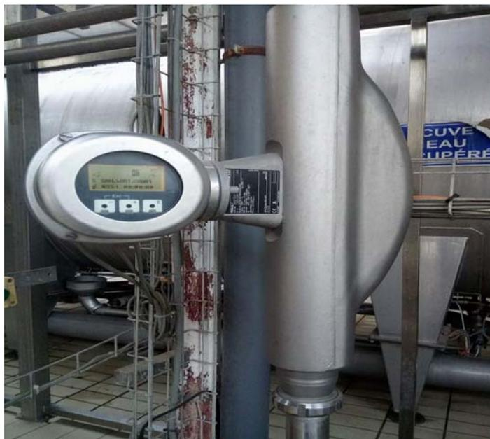
**Figure II.4 :** Aspect extérieur du débitmètre électromagnétique SITRANS F M MAG 5000/6000
