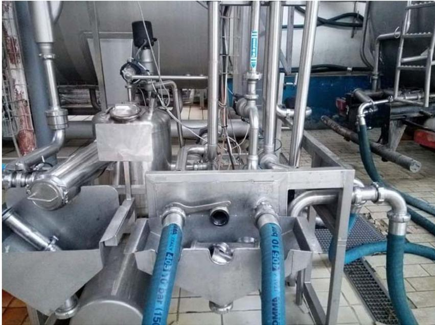
**Figure II.2 :** Illustration d'un Plateau de dépotage.
