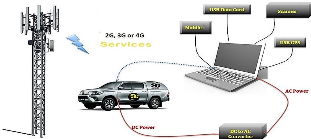
Figure II.8 : Exemple de chaîne de mesure pour un Drive Test [29].
