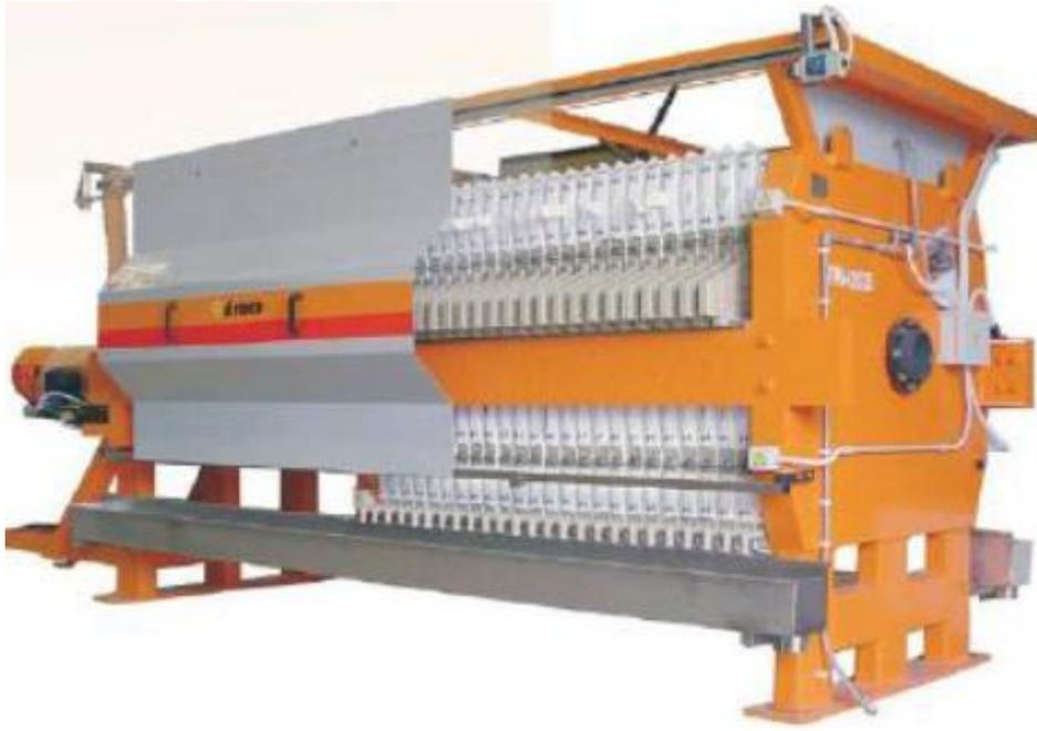
**Figure II.1 :** Schéma d'un filtre à presse.
