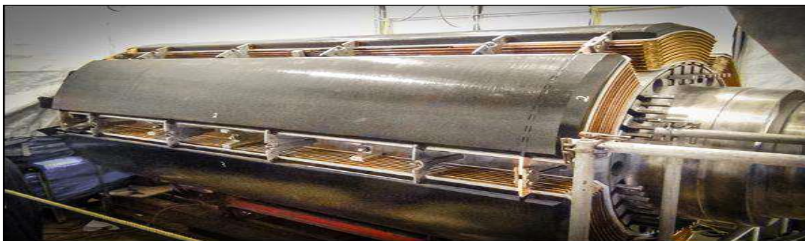
Figure 2.6 : Rotor à pôle saillant
