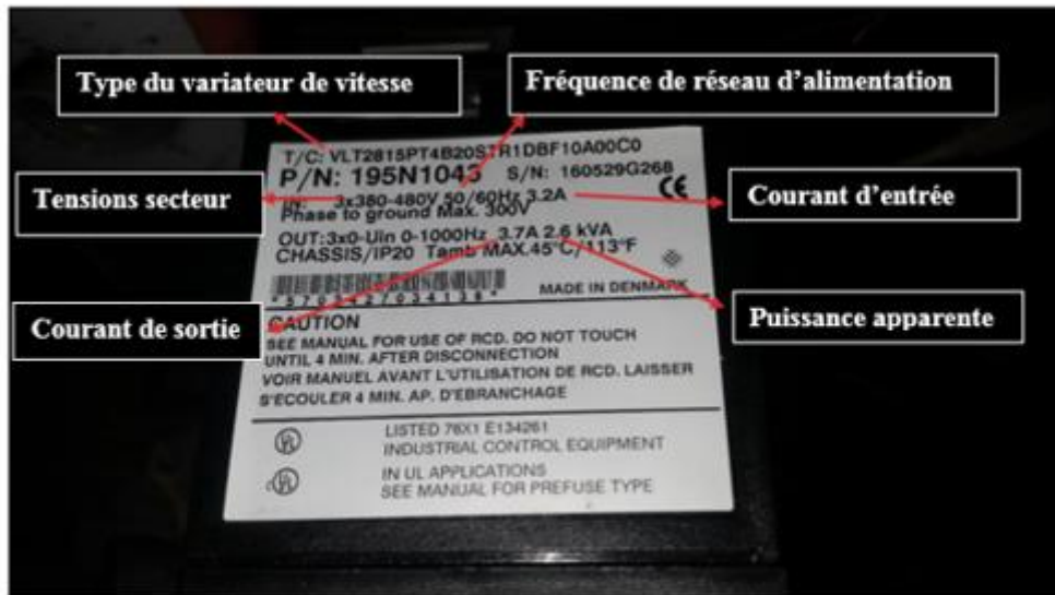
La plaque signalétique du variateur de vitesse (DANFOSS VLT -2800.)
