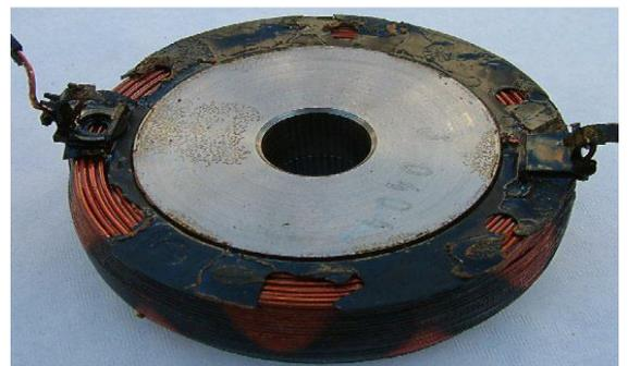
Figure III.30: Vue de la bobine d'excitation et du noyau de l'alternateur
