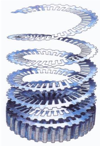
Figure III.28: Process slinky construction du stator en hélice
