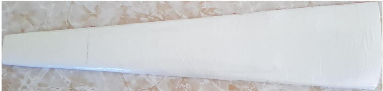
Figure III.15: La forme de la pale après le lissage (coté extrados)
