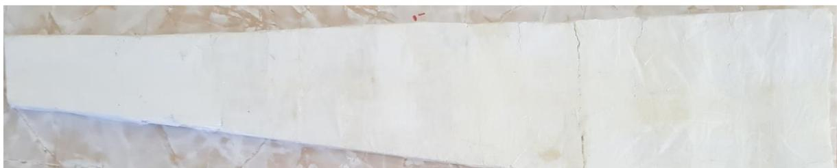
Figure III.14: Remplissage des vides avec du plâtre (coté intrados)
