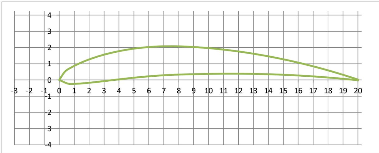
Figure III.2: Profil 1 de NACA 6409
