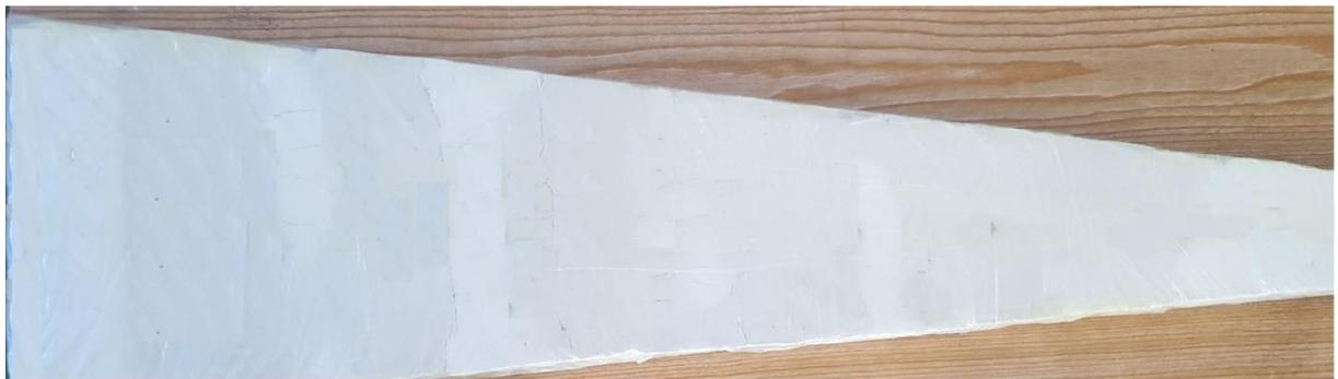
Figure III.16: La forme de la pale après le lissage (coté intrados)
