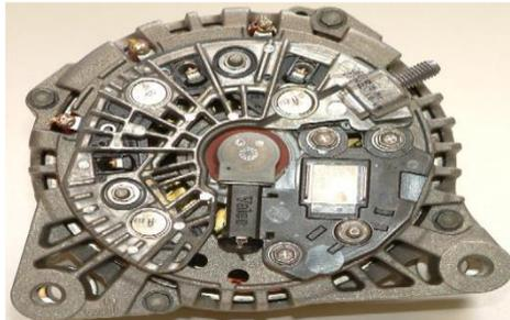
Figure III.31: Redresseur de l'alternateur
