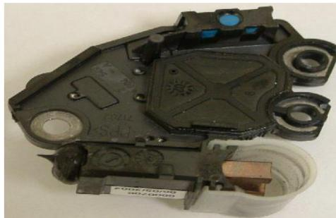
Figure III.32: Régulateur de l'alternateur
