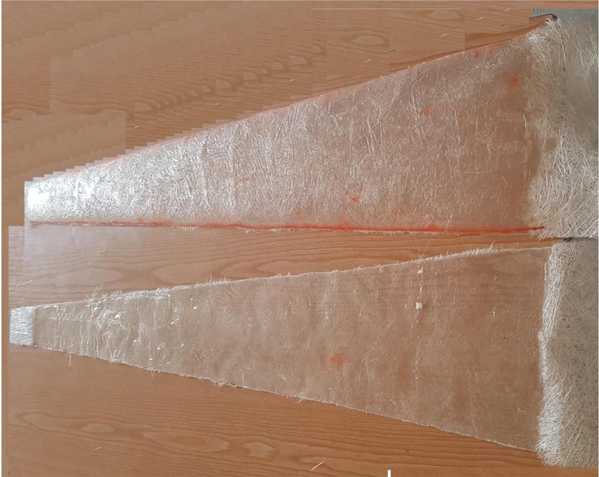
Figure III.19: La partie extrados et intrados fini
