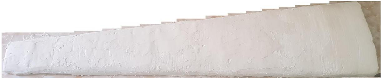
Figure III.13: Remplissage des vides avec du plâtre (coté extrados)
