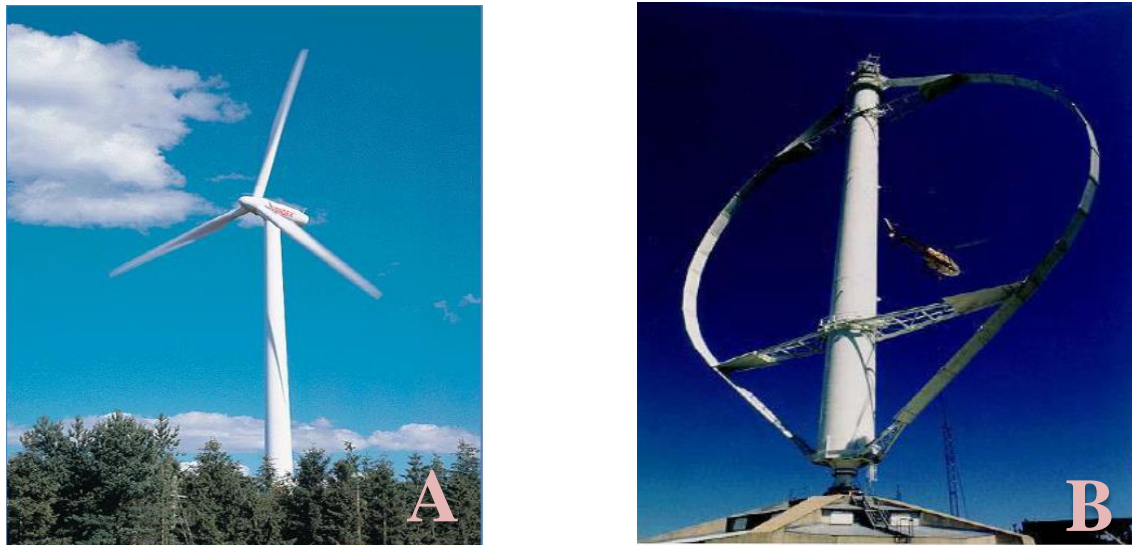
Fig.I.2 Différents types des éoliennes : A – à axe horizontal ; B – à axe vertical
