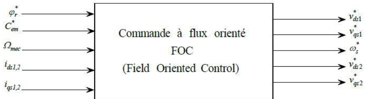
Figure 3.1 - Schéma de principe de la commande à flux orienté (FOC)
