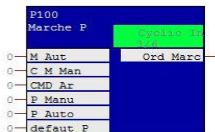
Figure IV.14 : Programmation marche/arrêt de la pompe P100.
