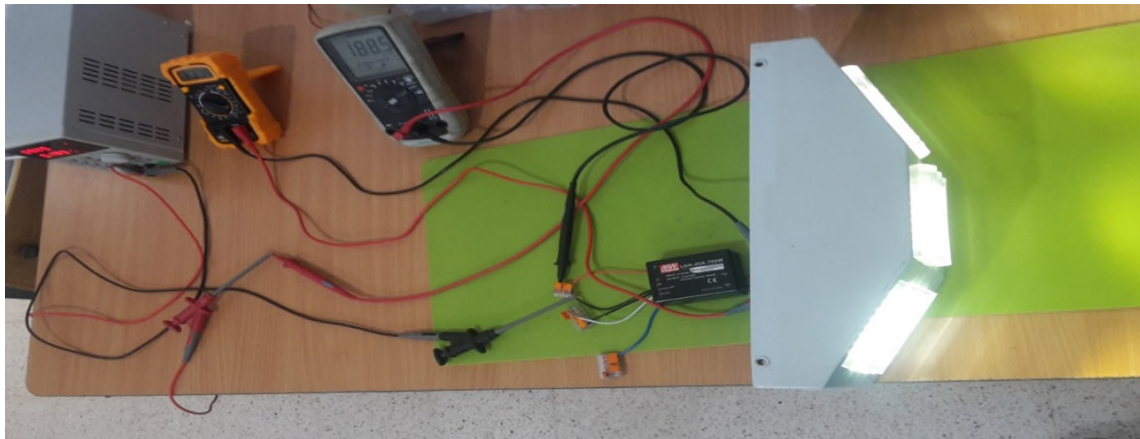
Figure III.19 Banc d'essai réalisé sur le hacheur.
