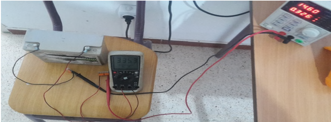
Figure III.26 Banc d'essai réalisé sur la charge d'une batterie
