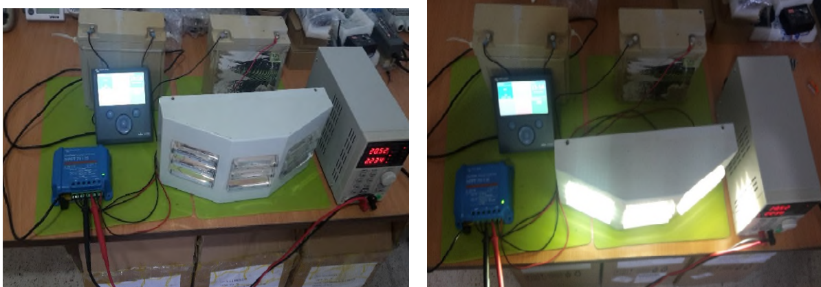
FigureIV.8 : Banc d'essai réalisé sur le régulateur.
