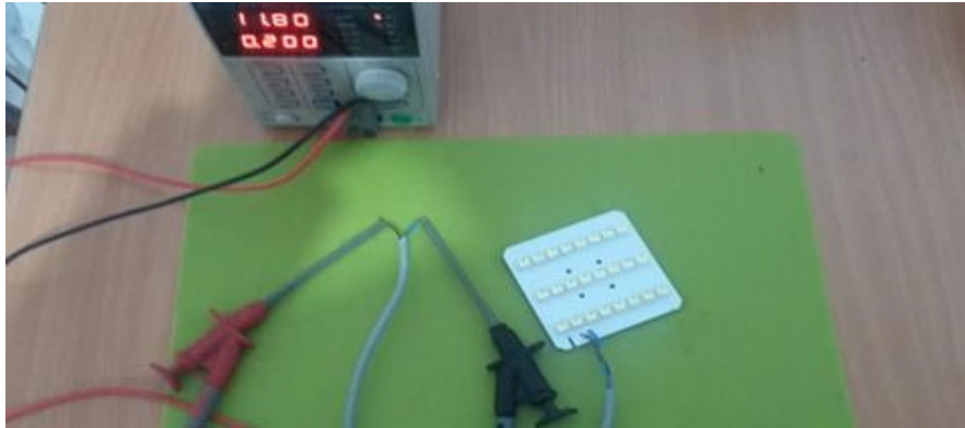
Figure III.7 Banc d'essai réalisé d'une carte à LED.
