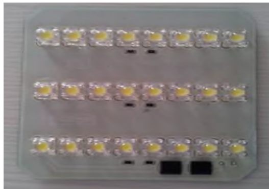
Figure I.4 Carte électronique - 24 LED [1]
