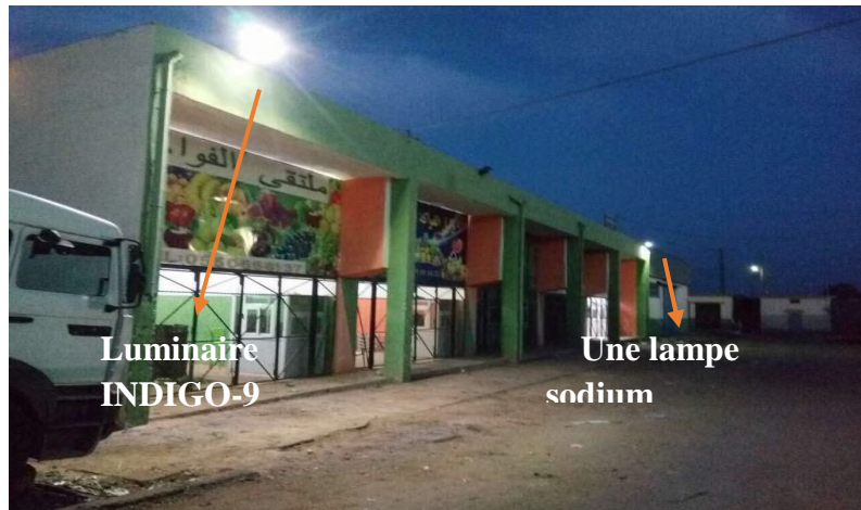
Figure I.11 La photo montre la qualité de l'éclairage de l'INDIGO-9, en premier plan, pour une consommation de 36W, et la comparaison avec une lampe sodium, en deuxième plan, de 250W. [1]
