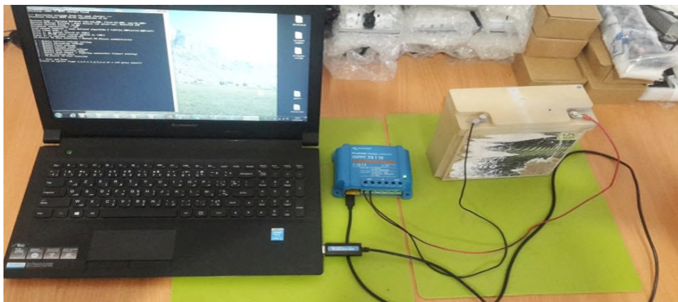
Figure IV.6 : régulateur victron connecté au PC.
