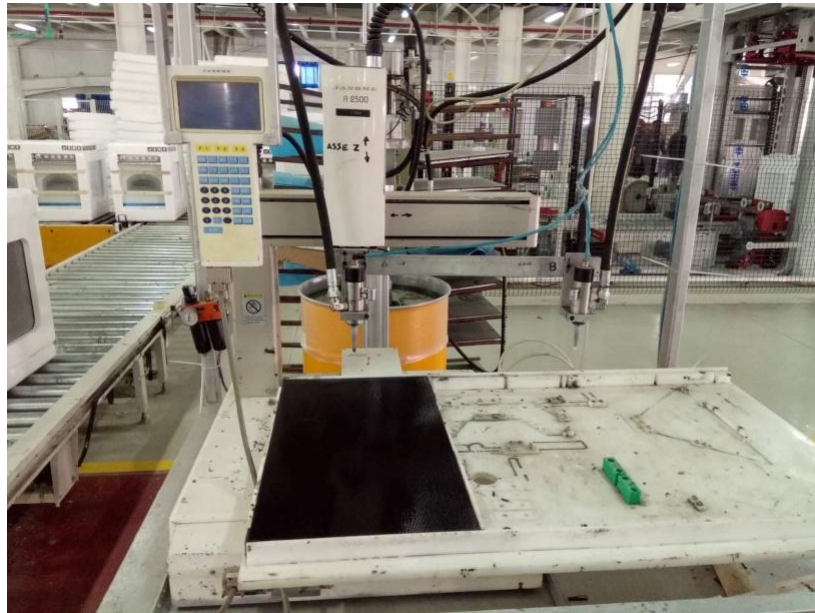
Figure I.17 Robot de pose de silicone sur les vitrocéramiques
