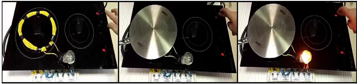
Figure I.8 Photographie montrant l'analogie Transformateur-Table à induction
