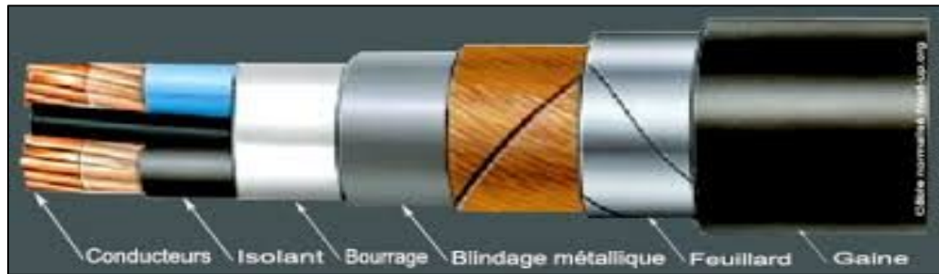
Figure IV.1. Constitution du câble électrique U1000R2V
