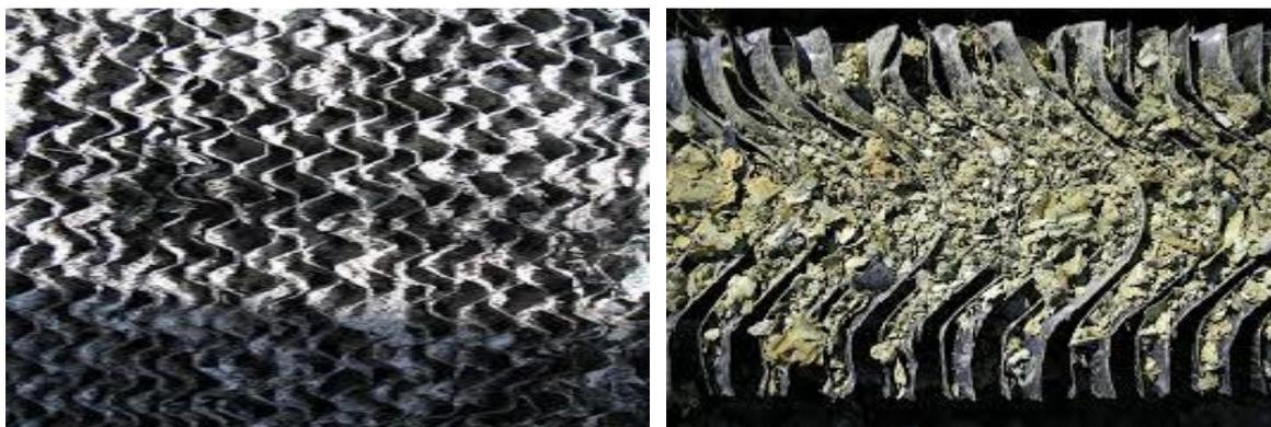
**Figure III.3:** Colmatage dans le corps d'échange
