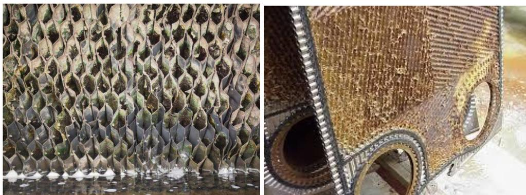
**Figure III.1:** L'encrassement dans le corps d'échange et l'échangeur à plaques
