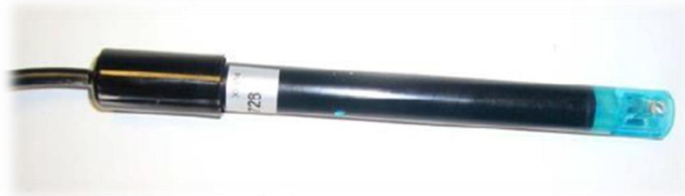
Figure (I.10) : Sonde utilisée pour la mesure de la conductivité du mélange boisson
