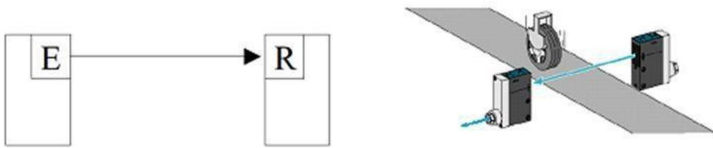
Figure IV-9 Principe de la détection de type barrage
