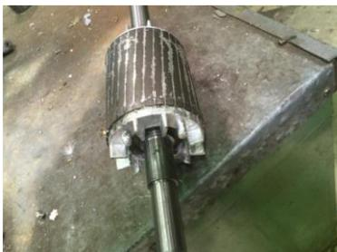
(a) Rotor à cage en aluminium.
