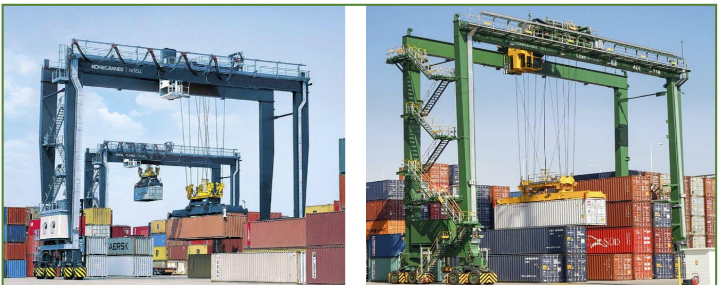
Figure 10 : Représentation d'une grue portique sur pneus RTG
