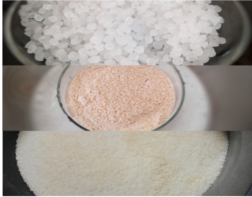
Figure10 : Mélange du polypropylène + farine de bois.
