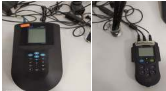
Figure III.20: a) Appareil multi-paramètres de paillasse, b) multi-paramètres portatif.
