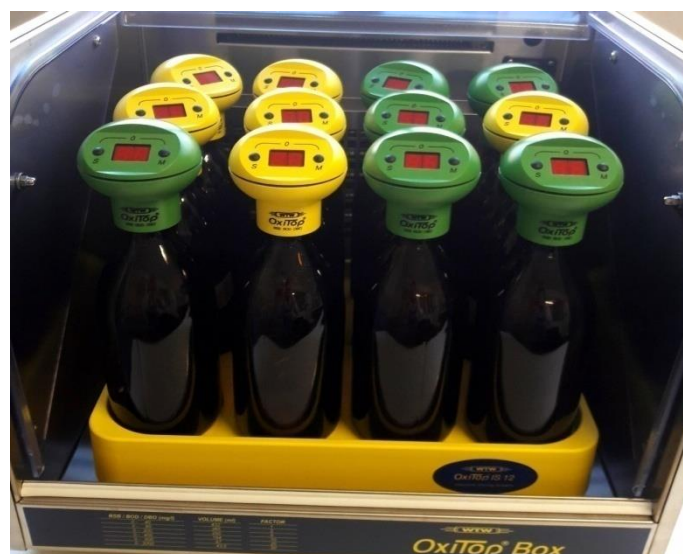
Figure III.7 : Appareil de mesure de la DBO 5 (OXITOP BOX).
