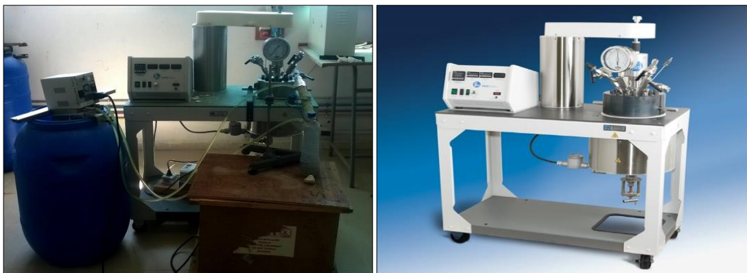
Figure II.4 : Autoclave système de réacteur sous pression série 4571 en configuration chariot utilisé dans notre travail.
