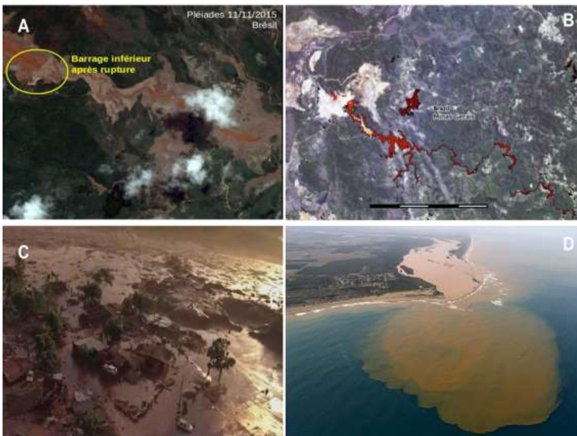
**Figure 2.2. Rupture du barrage de Fundao (Brésil) en 2015 : (A) image aérienne de la rupture du barrage, (B) image satellitaire montrant la coulée de boue le long de la rivière Doce, (C) Village englouti le long de la rivière, (D) déversement de la coulée de boue**
