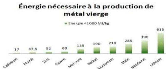
Figure 2.5.Énergie nécessaire a la production de métal vierge ( l'énergie des métaux /ecoinfo.cnrs.fr )
