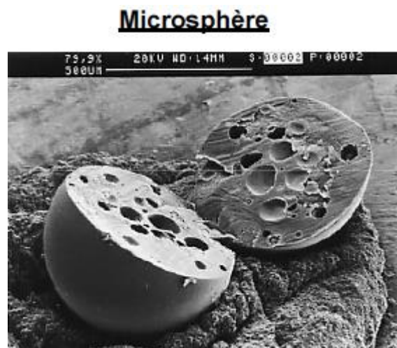
Figure III.13 : Photographie obtenues par microscopie électronique à balayage (MEB) représente : la microsphère dans laquelle le principe actif est dispersé dans le matériau enrobant [13].
