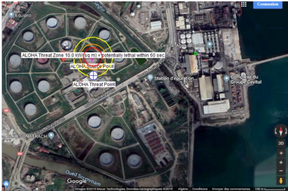
Figure3.8: Cartographie des flux thermique d'un feu de bac 4E2.
