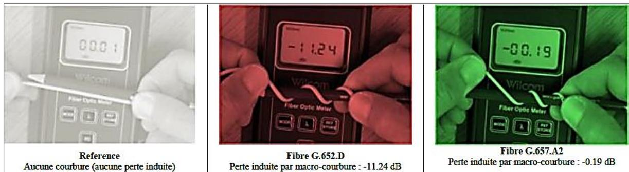
**Figure 1.** Exemples de pertes induites par macro-courbures à 1550nm pour deux échantillons de fibres G.652.D et G.657.A2 en considérant deux tours complets autour d'un crayon à papier [63].
