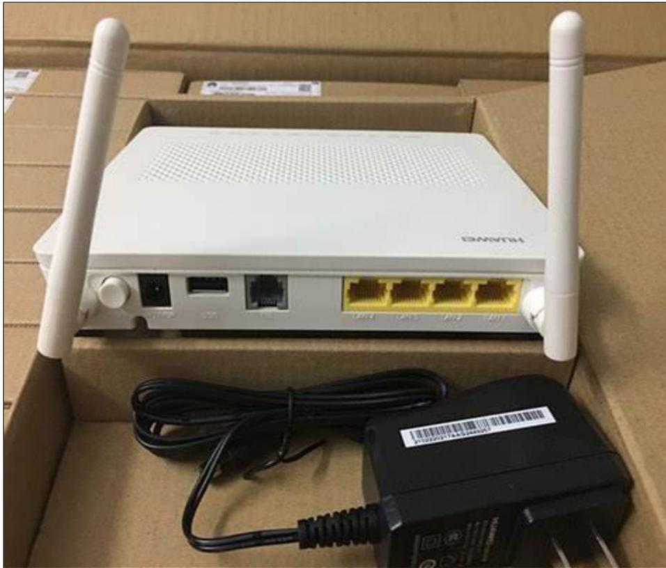
**Figure 12.** *Le terminal de réseau optique ONT*
