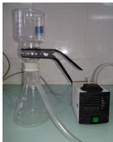
Figure II-4: Dispositif de filtration
