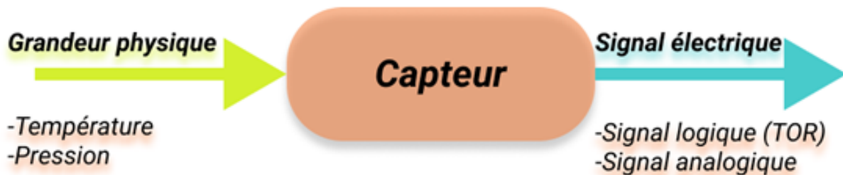
FIGURE III.8 – Représentation fonctionnelle de capteur.
