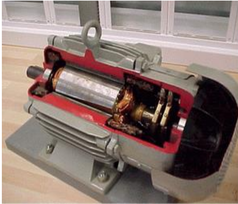
Figure I-8: Machines synchrones à rotor bobiné [13]
