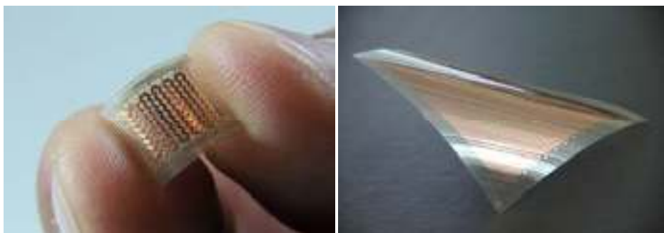
Figure I. 14 : Générateur thermoélectrique sur substrat souple Green TEG
