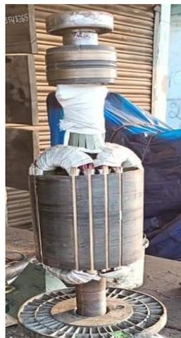
Figure I-9 Rotor à pôles lisses
