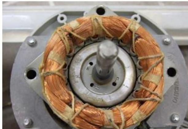
Figure I-6 Exemple d'un bobinage croisé concentré
