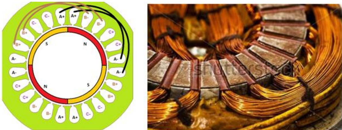
Figure I-5 Bobinage croisé réparti
