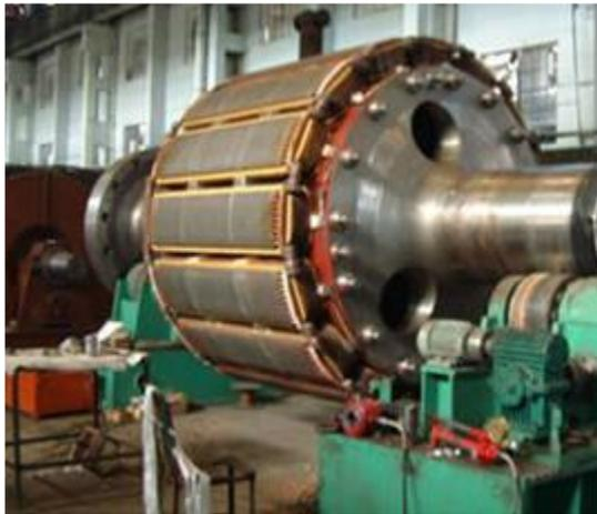
Figure I-10 Rotor à pôles saillants
