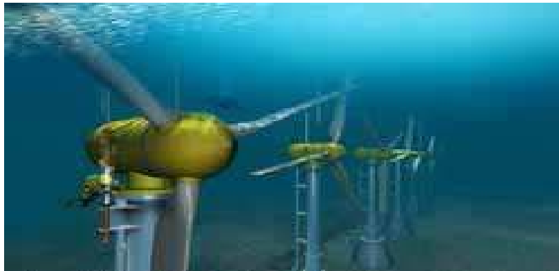
Figure I.2 : Ferme d'hydroliennes (projet Hammerfest Strom AS)
