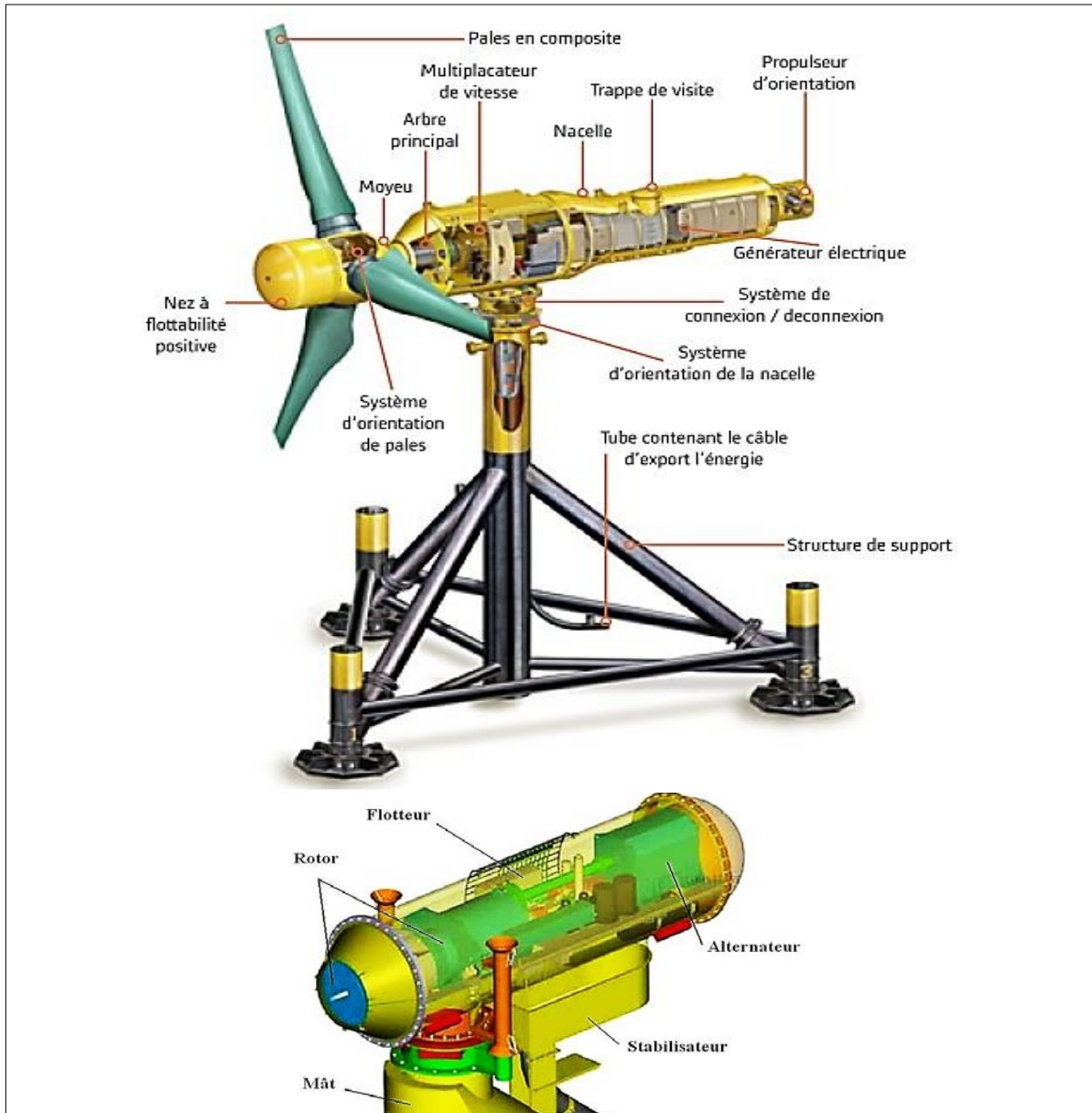
Figure I.4 : Composants d'un générateur hydrolienne (Source : Alstom)
