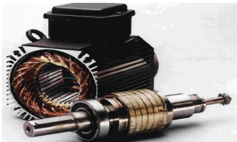
Figure I.24 : Structure de moteur synchrone à aimants permanents [31]
