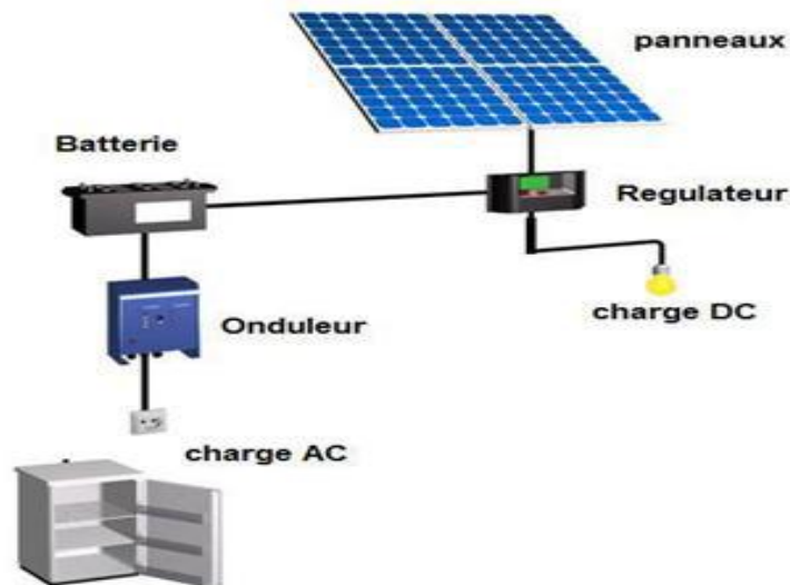
Figure I.9 : Système PV autonome avec batteries [19]
