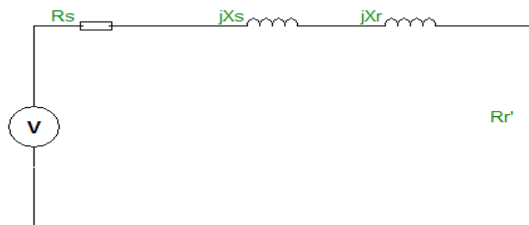
Figure III.5 : schéma équivalent d'essai a rotor bloqué
