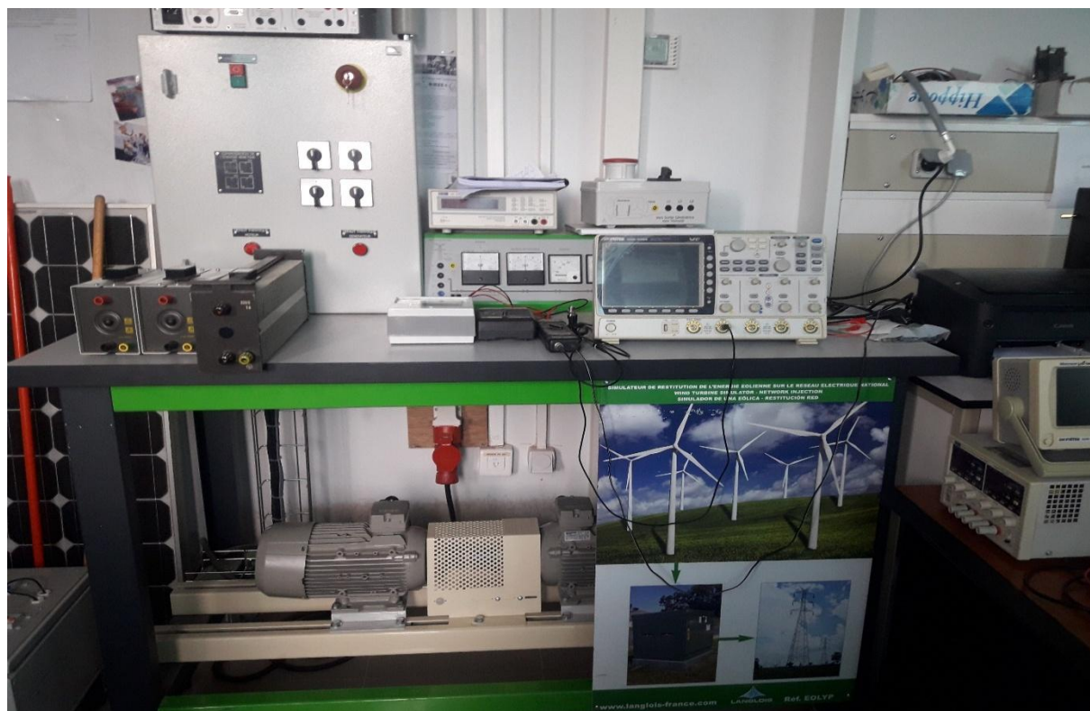
Figure IV.1 : Photo du banc d'essais d'un émulateur éolien
