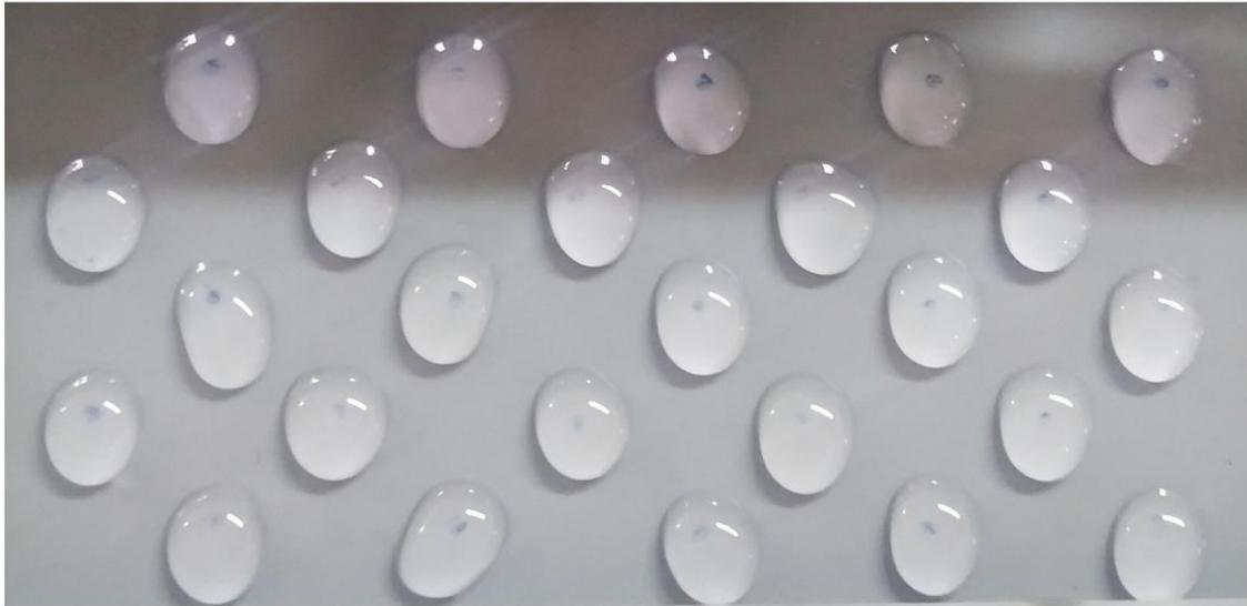
**Fig. 14:** Allongement sans chute des gouttes d'eau de volume  $90 \mu\text{l}$  sous  $0^\circ < \alpha < 11^\circ$
