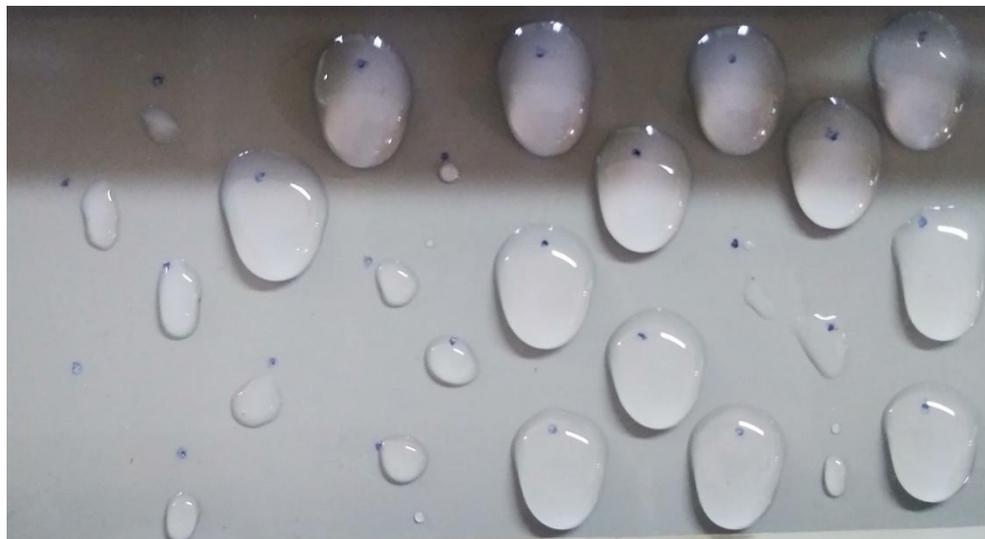
**Fig. 8:** Chute partielle des gouttes d'eau allongées de volume 120µl sous  $15^\circ < \alpha < 30^\circ$
