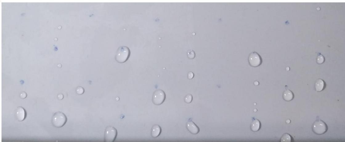
**Fig. 16:** Gouttes d'eau résiduelles de volume  $90 \mu\text{l}$  sous  $\alpha \geq 30^\circ$
