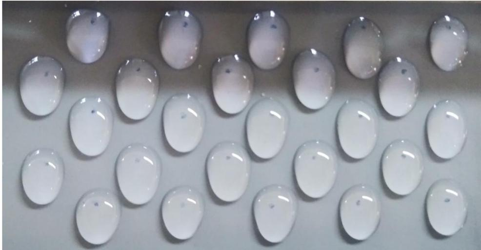
**Fig. 7:** Allongement des gouttes d'eau de volume 120µl sous  $0^\circ < \alpha < 11^\circ$
