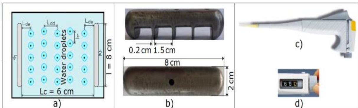
**Fig. 1:** Arrangement en zigzag des gouttes d'eau sur la surface de l'isolation en silicone délimitée par deux électrodes et micropipette (a: modèle expérimental, b: électrodes à dents HT et terre, c: micropipette graduée, d: ajustement du volume de 10 à 100 µl
