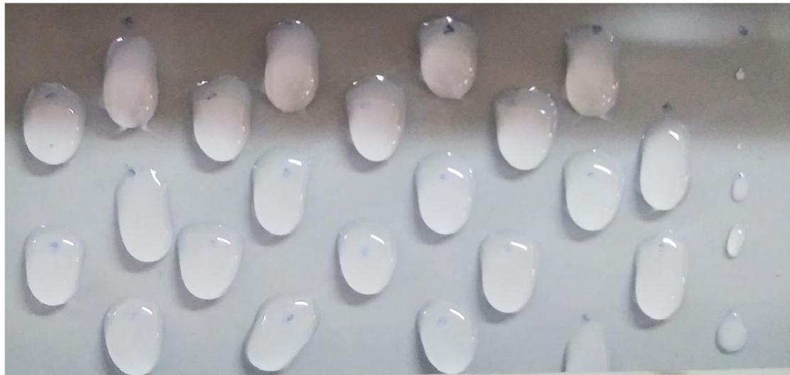
**Fig. 15:** Chute partielle des gouttes d'eau allongées de volume  $90 \mu\text{l}$  sous  $15^\circ < \alpha < 30^\circ$
