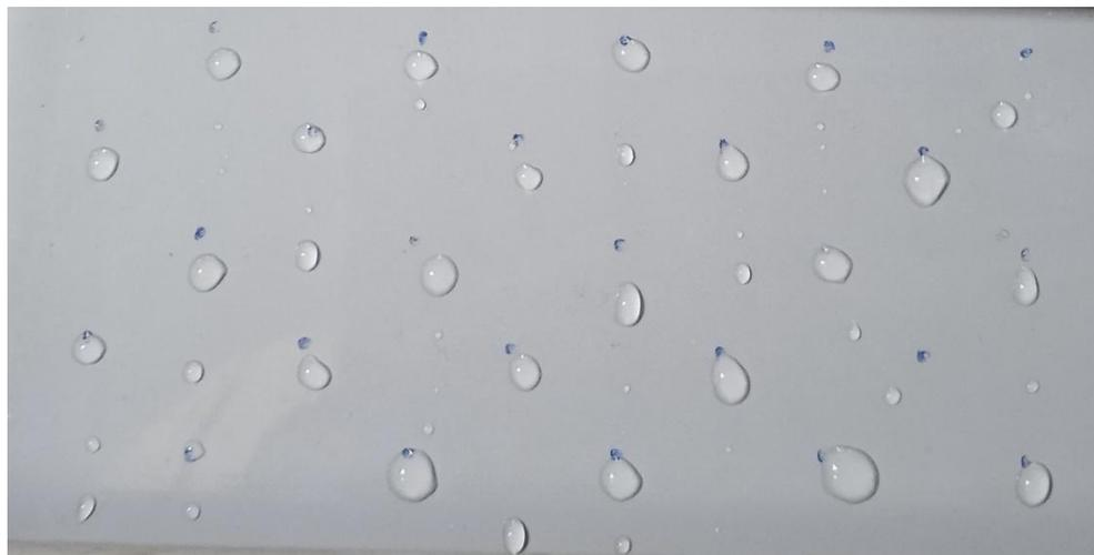
**Fig. 9:** Gouttes d'eau résiduelles de volume 120µl sous  $\alpha \geq 30^\circ$
