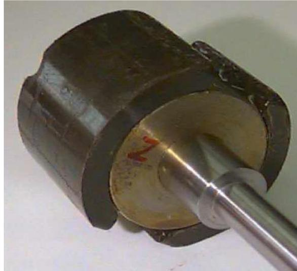
Figure I.2: exemple d'un rotor à aimants [3]
