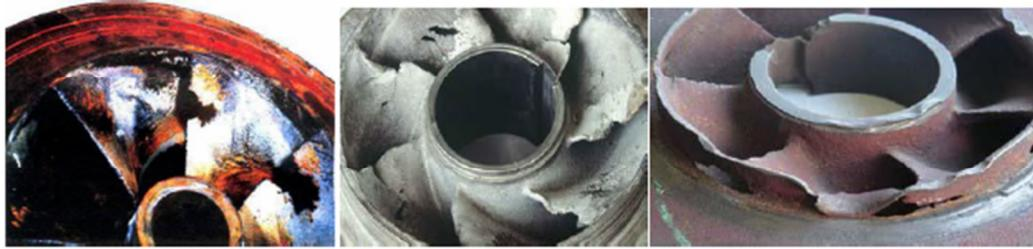
**Figure IV.11 : Cavitation d'une roue [15]**
