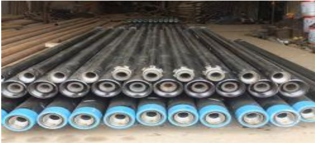
Figure I.11. Les tiges de forage.
