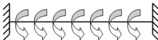
**Figure III.10. 2** Les moments de torsion sur la poutre palière.
