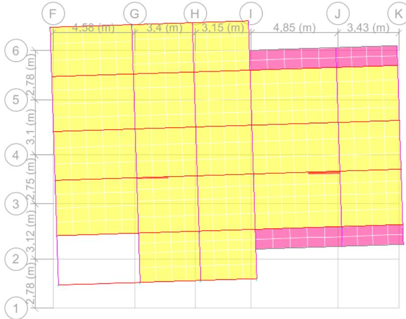
**Figure IV. 9.** Mode 1 de déformation (translation suivant l'axe Y-Y) bloc D
