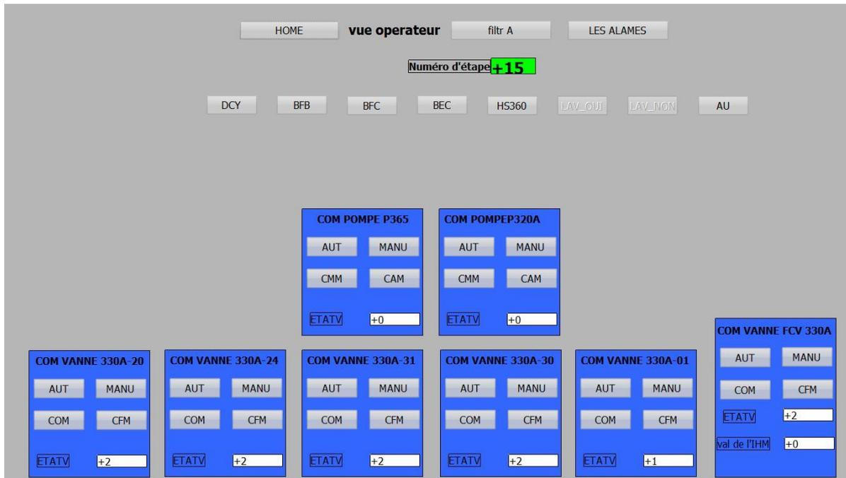
Figure IV.42 : Vue opérateur rinçage par l'issu d'entrée.
