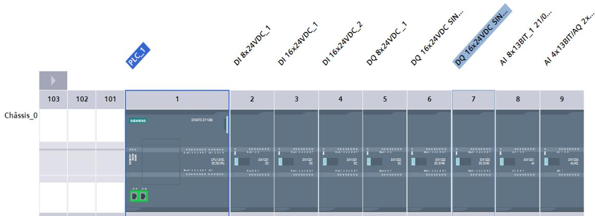
Figure IV.1 : Configuration matérielle PLC.
