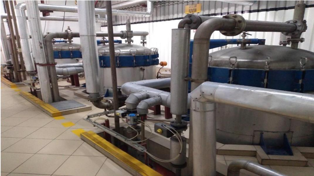
**Figure II.4 :** image réelle des filtres NIAGARA
