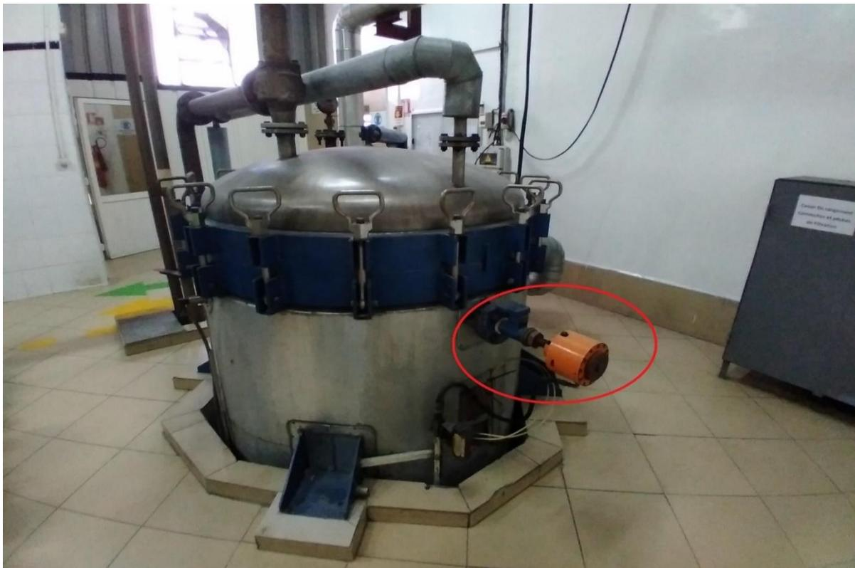
**Figure II.18 :** le système pneumatique (MT330A) de filtre NIAGARA.
