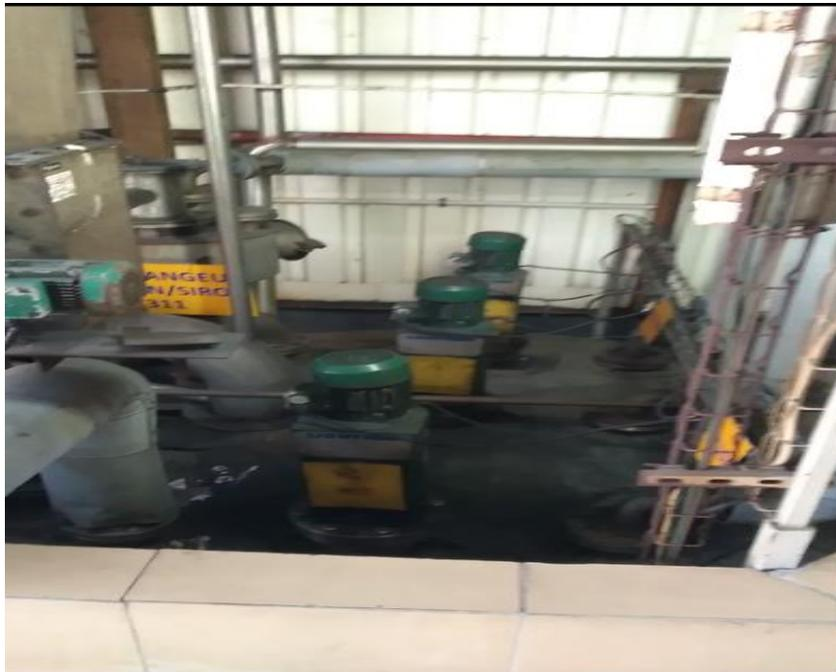
**Figure II.1** : image réelle des 3 agitateurs
