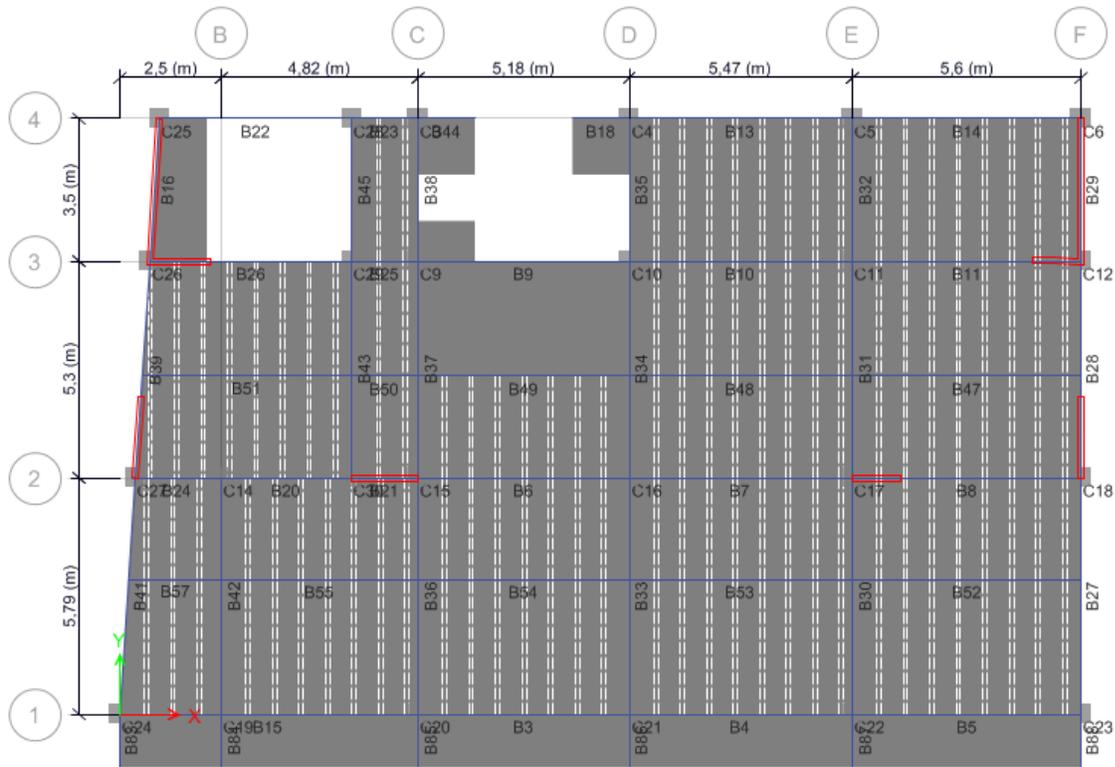
**Figure II.2.** la disposition des poutrelles ainsi que l'emplacement des poteaux les plus sollicités (étage 1).
