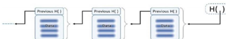
Figure 2.3 – Enchaînement des blocs [46]
