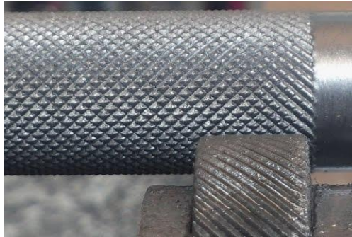
Figure I-8: surface cylindrique avec moletage croisé [3]
