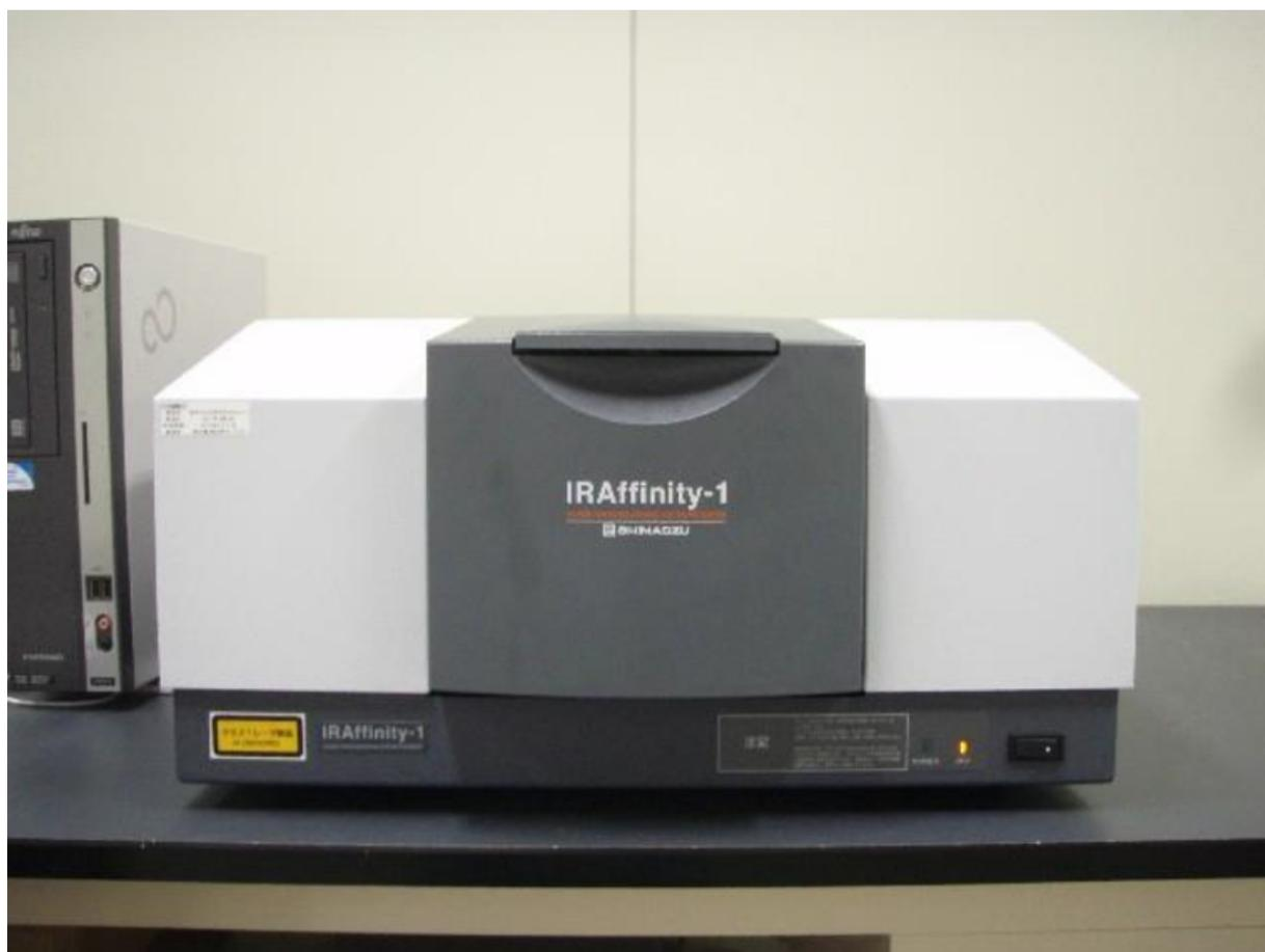
FIGURE II.6 – L'appareil IRAffinity-1 utilisé pour l'analyse IRTF
