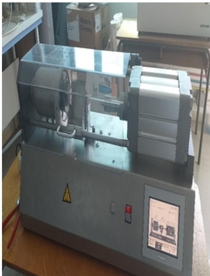
FIGURE II.5 – Appareil moulage par injection
