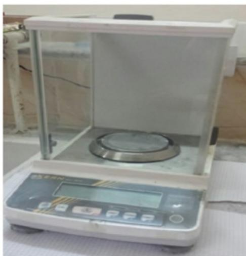
FIGURE II.7 – Balance analytique
